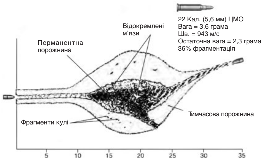
Рис. 1-6. Ідеалізований шлях розриву тканин, викликаного кулею М-193, якою вистрілили з гвинтівки М-16А1 (як симулятор використали 10% желатиновий блок). Кал.: калібр; ЦМО: цільнометалева оболонка; Шв.: швидкість.
