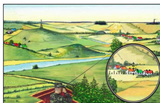
Рисунок 3 визначення відстані за підмогою бінокля
