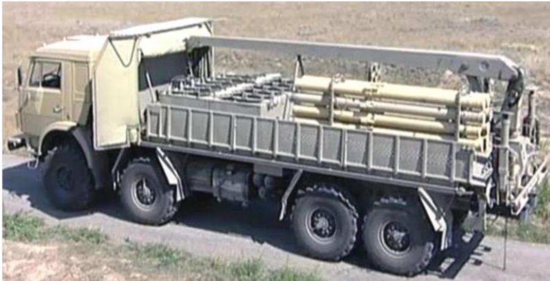
Рис. 2.176 – ТЗМ з контейнерами ЗКР і касетами 30-мм пострілів ЗРГК “Панцирь-С1”
