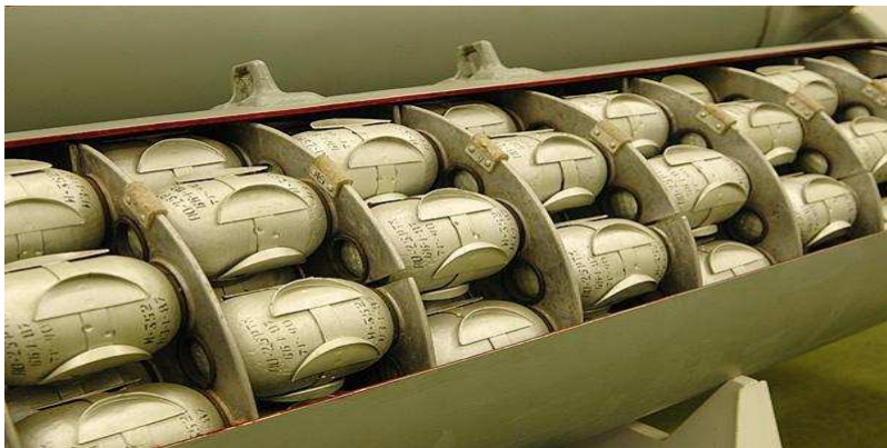
Рис. 2.104 – Разова бомбова касета РБК-500 АТ-2,5РТМ у розрізі
