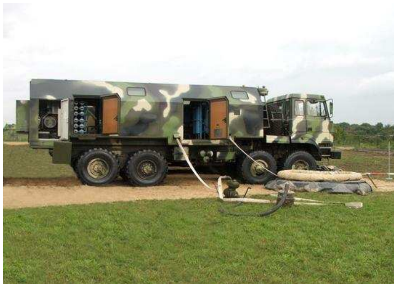
Рис. 1.151 – Станція комплексного очищення й опріснення води СКО-10/5
