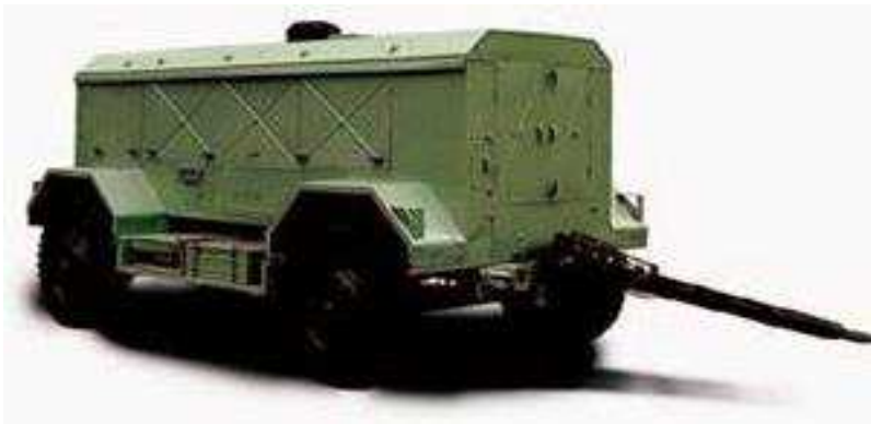
Рис. 2.117 – Зовнішній вигляд уніфікованої компресорної станції УКС-400
