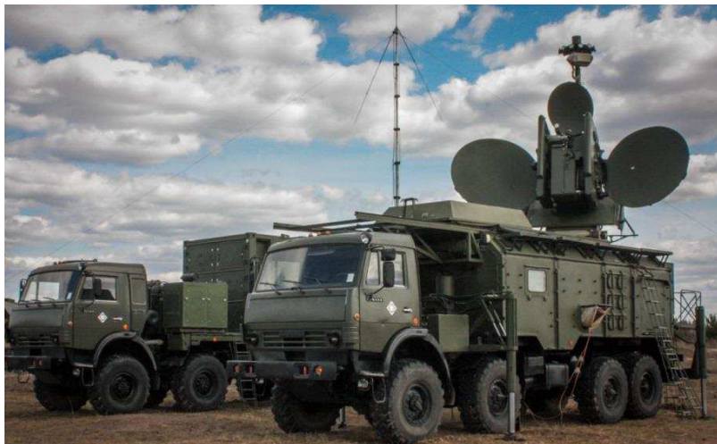
Рис. 6.17 – Станція потужних шумових перешкод 1РЛ257 “Красуха-4”
