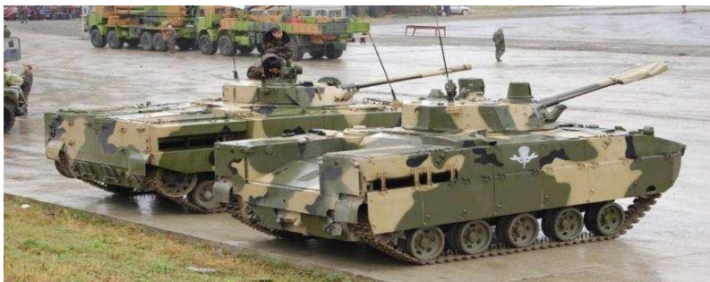
Рис. 5.9 – Різниця в компонуванні десантного відділення в бойовій машині десанту БМД-4М (ліворуч) та БМД-4 (праворуч, класична для всіх попередніх версій БМД та БТР-Д)
