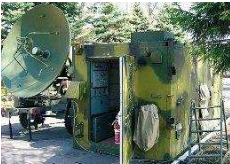
Рис. 1.203 – Станція супутникового зв'язку контейнерна вузлова Р-439-КУЛ
