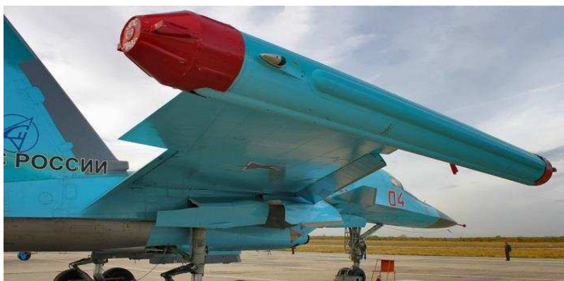
Рис. 2.121 – Комплекс РЕБ “Хибины”
