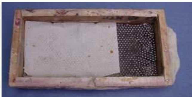
Фото 40. Протипіхотний СВП, замаскований під цеглину
