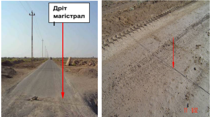
Фото 44. Саморобний вибуховий пристрій, керований за допомогою дротів
