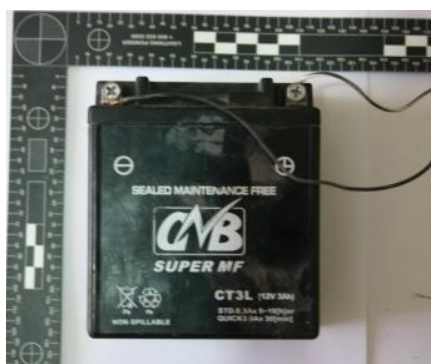
Фото 14, 15. Джерела живлення детонаторів: батарейки, акумулятор
